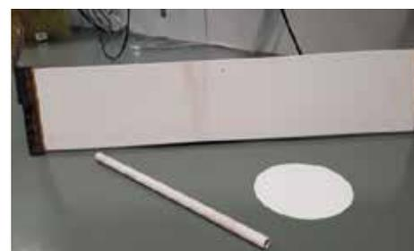
Verschiedene Typen von Membranen (Keramik, Polymer), mit denen sich partikuläre Bestandteile (Krankheitserreger, Antibiotikaresistenzgene, antibiotikaresistente Bakterien und zum Teil auch Viren) aus dem Abwasser entfernen lassen. (Foto: H. Horn, KIT-EBI)
